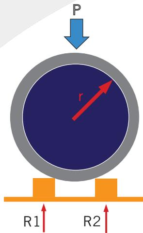
La separación de los apoyos inferiores debe ser de 0.08 del diámetro interior del tubo con las aristas redondeadas.
